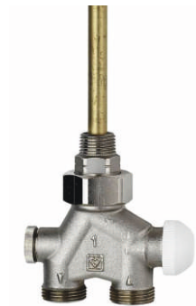
Uronski ventil za sušač za jednocevne i dvocevne sisteme "Herz" priključak grejnog tela sa donje strane, ravno zaptivanje, sa uronskom cevi L=150mm Dimenzija: 1/2" Pakovanje: 10kom.
