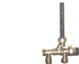
Donji deo usponskog ventila sa podesivim protokom za jednocevni odnosno dvocevni sistem grejanja i podesivim izvodima prema zidu odnosno podu art. 875 "Icma" Pakovanje 10kom.
