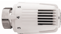
Termo glava STANDARD "Herz" sa hidrosenzorom Opseg zadavanja vrednosti 6-28°C. Zaštita od smrzavanja na 6°C. Mogućnost ograničavanja i blokiranja oblasti zadavanja pomoću graničnika (posebno se naručuje) Dimenzija: 1/2" Pakovanje: 20 kom.
