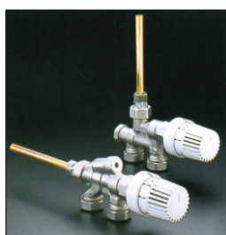
Uronski ventil sa uronskom cevii termostatskom opcijom za jednocevni sistem grejanja od 20-50%protoka 1/2".
