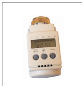
Elektronski regulator "Oventrop" služi za regulaciju temperature po pojedinoj prostoriji prema vremenskom programu koji se može slobodno nameštati. Radi bez mrežnog priključka, pomoću dve uobičajene baterije. Opremljen je zaštitom za decu, zaštitom od smrzavanja i prozorskom funkcijom. Područje zadate vrednosti: 8 - 28°C Navojni priključak: M 30 x 1,5
