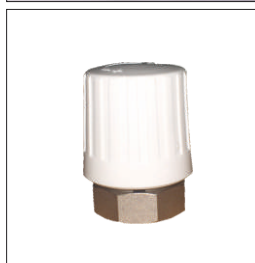
Elektronski regulator "Oventrop" služi za regulaciju temperature po pojedinoj prostoriji prema vremenskom programu koji se može slobodno nameštati. Radi bez mrežnog priključka, pomoću dve uobičajene baterije. Opremljen je zaštitom za decu, zaštitom od smrzavanja i prozorskom funkcijom. Područje zadate vrednosti: 8 - 28°C Navojni priključak: M 30 x 1,5
