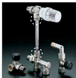
Usponski ventil gornji deo 1/2" Usponski ventil donji deo 1/2" 50% protok 100% protok Priključna steznica Cofit (označeno na slici) za spoj usponske cevi i ventila "Oventrop" - 2kom u setu Za kompletiranje usponskog ventila potrebna je ručna kapa ili termostatska glava
