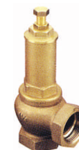
Samoštelujući ventil sigurnosti sa oprugom art. 254 "Icma" Izlazni pritisak 0 - 9 bara Max ulazni pritisak 16 bara Dimenzije: 1/2"; 3/4"; 1"; 1 1/4"; 1 1/2"; 2"; 2 1/2"; 3" Pakovanje na kom.
