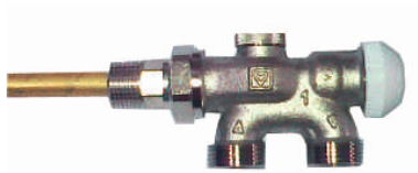
Uronski ventil za jednocevne i dvocevne sisteme "Herz" priključak grejnog tela sa donje strane, ravno zaptivanje, sa uronskom cevi L=290mm Dimenzija: 1/2" Pakovanje: 10kom.
