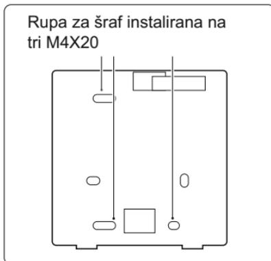
Rupa za šraf instalirana na tri M4X20
