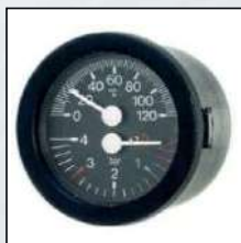
Model - TI 52 P Termomanometar sa kapilarnom Ø 52 Temperatura 0 - 120°C Pritisak 0 - 6 bar Dužina kapilara 150 cm
