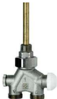
Uronski ventil za sušać za jednocevne i dvocevne sisteme "Herz" priključak grejnog tela sa donje strane, ravno zaptivanje, sa uronskom cevi L=150mm Dimenzija: 1/2" Pakovanje: 10kom.
