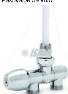
Uronski ventil hromirani + uronska cev (400 mm) za cevne radijatore (sušaće) za jednocevnog odnosno dvocevnog sistema grejanja sa podešivim izvodima za cevi prema zidu odnosno podu art. 938 "Icma" Dimenzija: 1/2" Pakovanje na kom.
