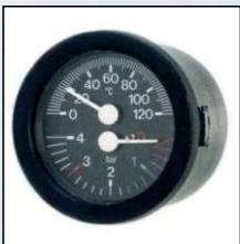
Model - TI 52 P Termomanometar sa kapilalom Ø 52 Temperatura 0 - 120°C Pritisak 0 - 6 bar Dužina kapilara 150 cm
