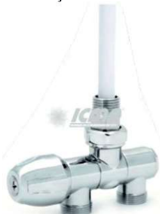
Uronski ventil hromirani + uronska cev (400 mm) za cevne radijatore (sušače) za jednocevni odnosno dvocevni sistem grejanja sa podesivim izvodima za cevi prema zidu odnosno podu art. 938 "Icma" Dimenzija: 1/2" Pakovanje na kom.
