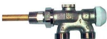
Uronski ventil za jednocevne i dvocevne sisteme "Herz" priključak grejnog tela sa donje strane, ravno zaptivanje, sa uronskom cevi L=290mm Dimenzija: 1/2" Pakovanje: 10kom.
