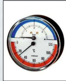
Termomanometar ABS Temperatura 0 - 120°C Pritisak 4 bar Axialni priključak Dimenzija: Ø 80 - 1/2"
